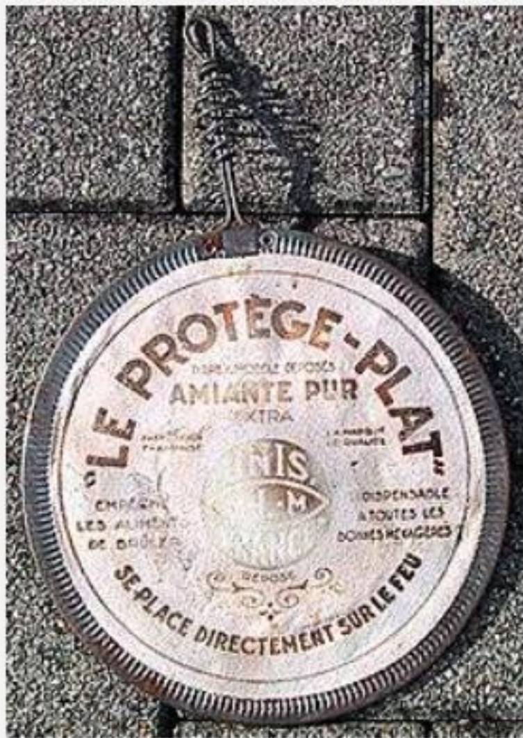
Sotto Pentola in puro amianto.
