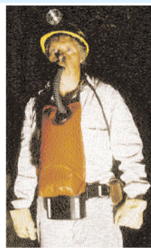
Appareil isolant autonome à génération d'oxygène ( KO_2 ) (photo Fenzy).
