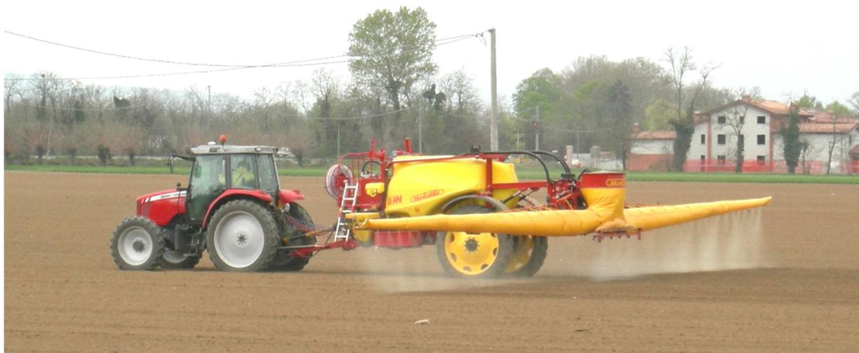
[Foto 3 - trattore con irroratrice a barra trainata aeroassistita]
