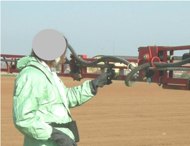
[Foto12 - il lavoratore indica gli ugelli montati sulla barra]
